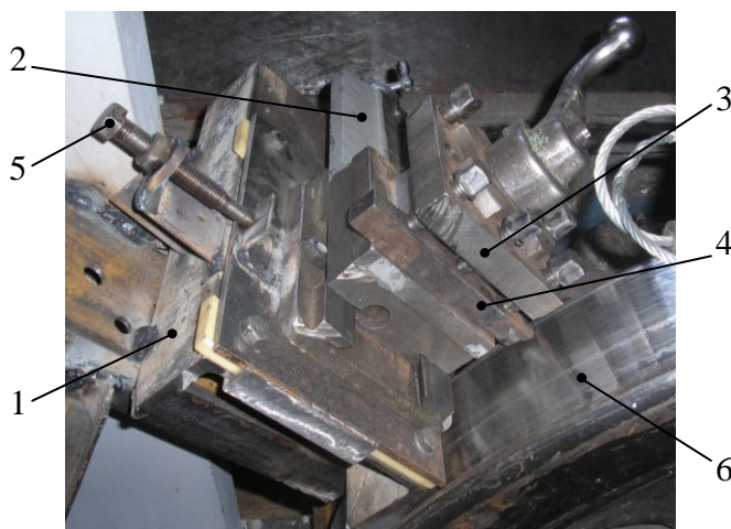
Рисунок 2 - Устройство для обработки резанием поверхности катания колеса локомотива
