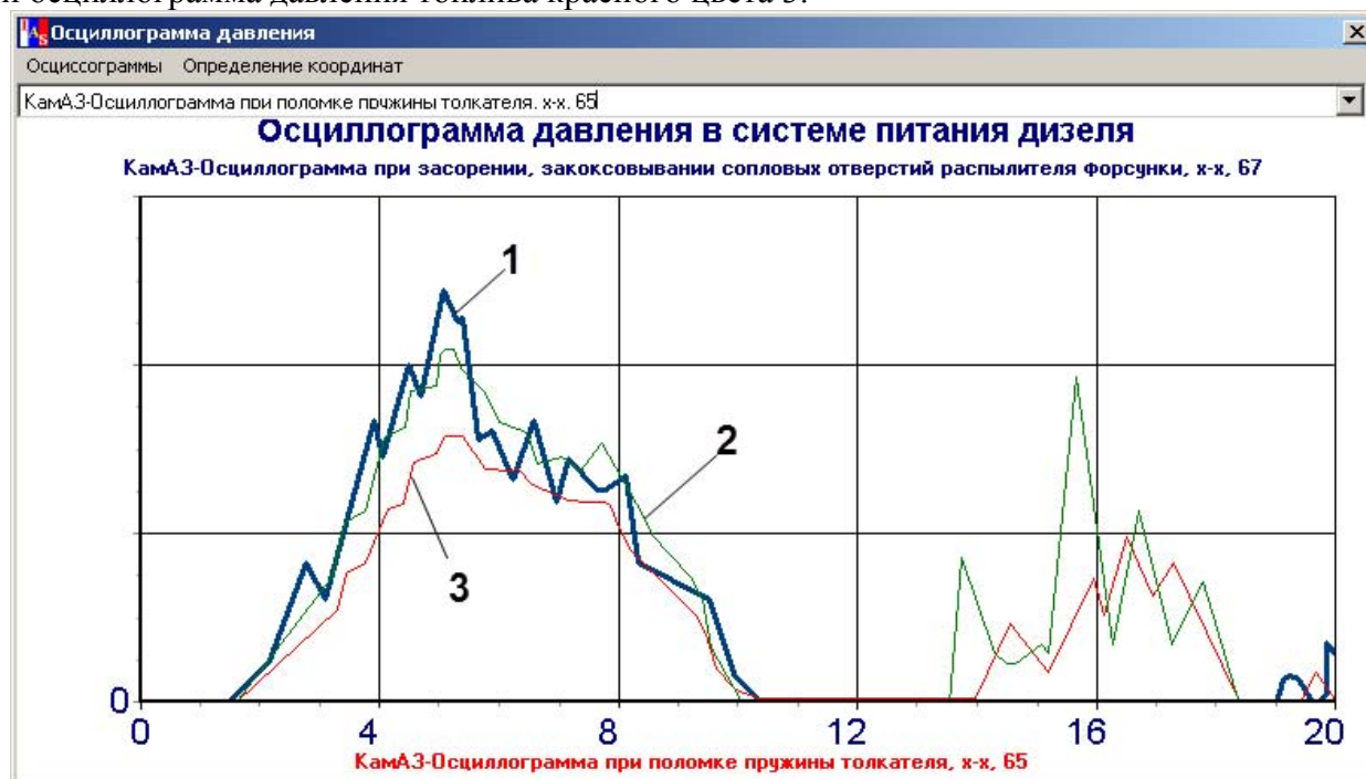
Рисунок 3 - Окно с осциллограммами комплекса КАД-400
