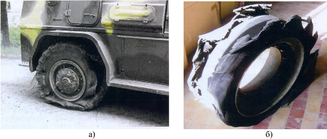
Рисунок 4 – Движение автомобиля ГАЗ-39371 на пневматической шине с ВДО «сплошного» типа (а) и дальнейший ее разрыв (б)
