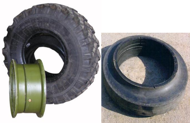
Рисунок 1 – «Безопасное» колесо с бескамерной пневматической шиной, разъемным ободом и внутренней опорой «сплошного» типа [8]
