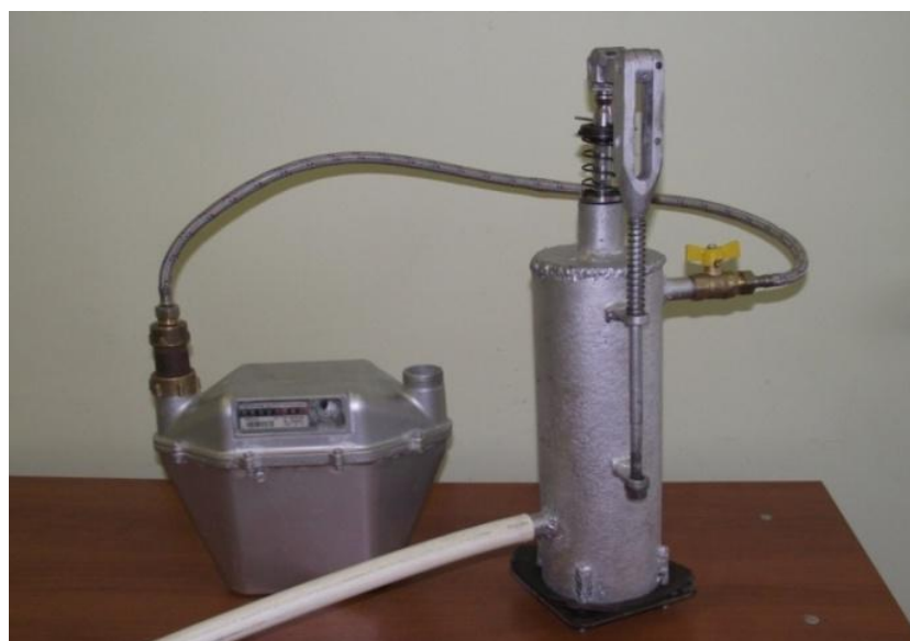
Рисунок 2 - Макетный образец газораспределительного механизма
