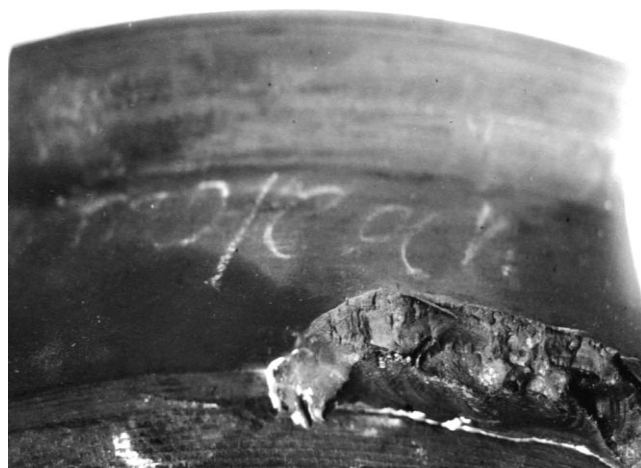
Рисунок 5 – Откол гребня бандажа колесной пары электровоза ПЭ2 М № 19
