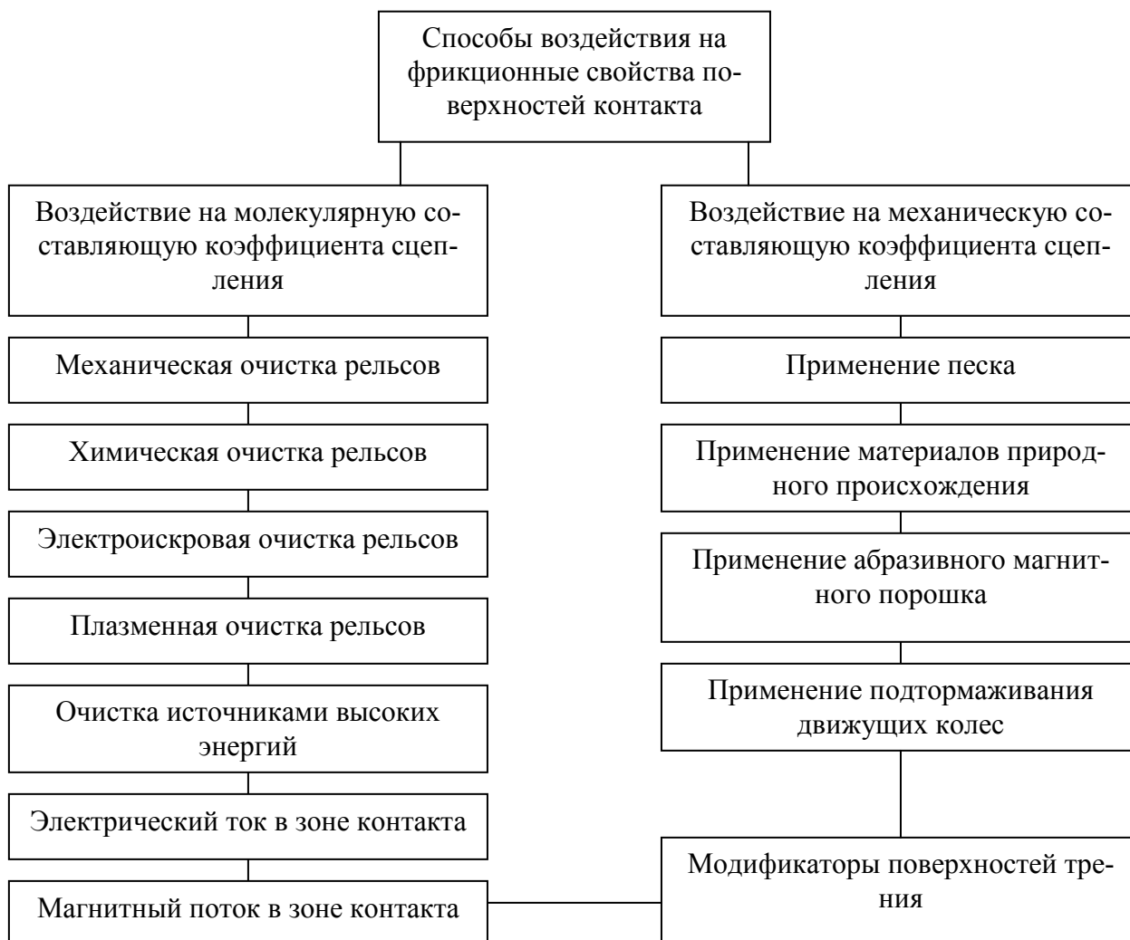
Рисунок 1 – Классификация способов воздействия на фрикционные свойства поверхностей контакта
