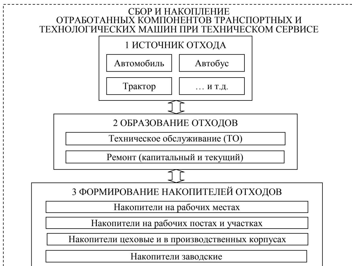
Рисунок 1 – Схема структуры сбора и накопления отработанных компонентов транспортных и технологических машин
