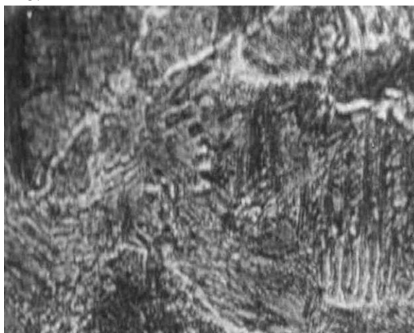
Рисунок 7 – Микроструктура металла, наплавленного проволокой 30ХГСА (просто-мартенсит)
