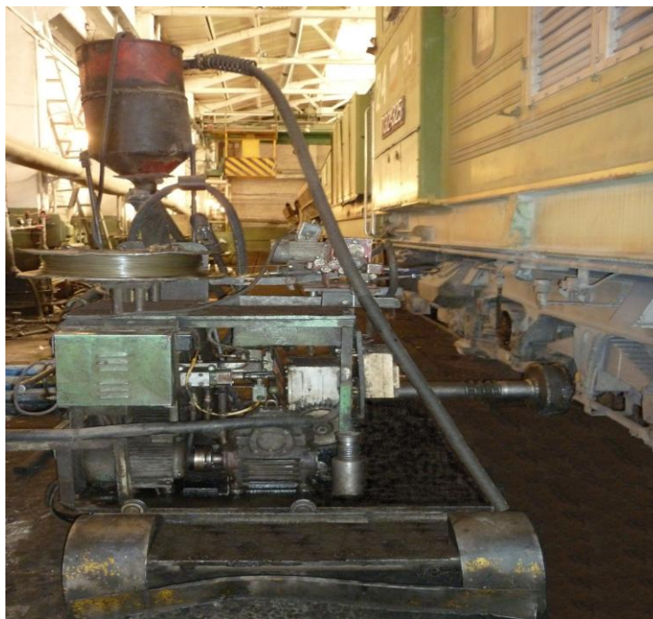
Рисунок 3 – Вид установки для наплавки гребней бандажей без выкатки колесных пар из-под электровоза
