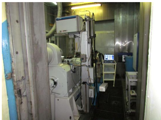
Рисунок 7 – Установка для проведения обкатки двигателя на основе обратной связи
