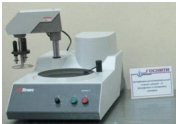
Рисунок 7 – Общий вид шлифовально-полировального станка LaboPol-5 “Struerus”
