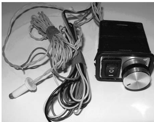
Рисунок 3 - Внешний вид автомобильного устройства регулирования микроклимата
