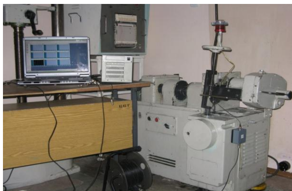
Рисунок 1 - Триботехнический комплекс для исследований процесса приработки сопряжений
