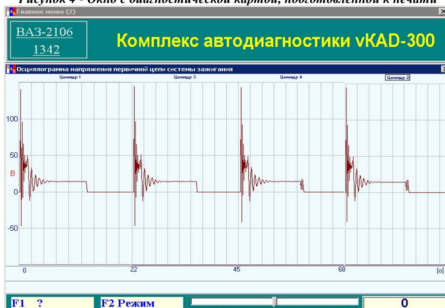
Рисунок 5 - Осциллограмма изменения напряжения первичной цепи системы зажигания
