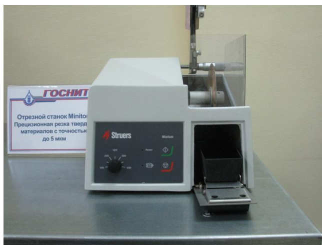
Рисунок 5 – Общий вид высокоточного отрезного станка Minitom “Struerus”
