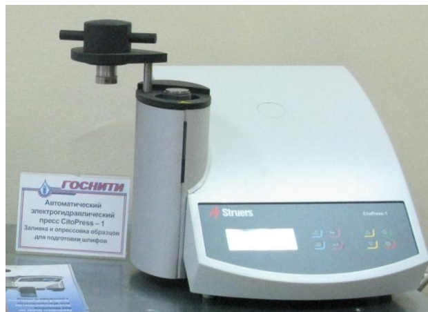
Рисунок 6 – Общий вид автоматического электрогидравлического пресса CitoPress-1 “Struerus”
