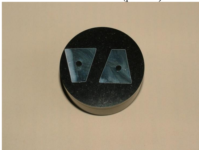
Рисунок 4 – Общий вид поперечных шлифов
