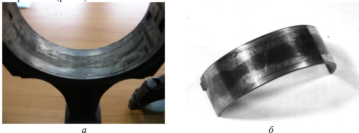
Рисунок 3 - Следы фреттинг-изнашивания на нижней головке шатуна -а и вкладыше -б
