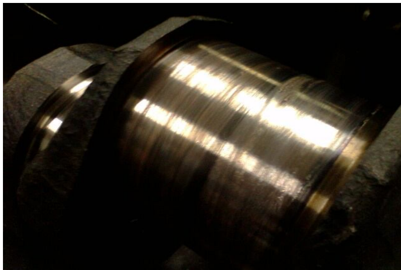
Рисунок 4 - Задиры на шейке вала, результат схватывания с вкладышем
