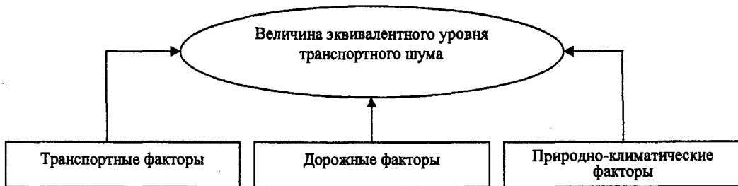
Рисунок 1 - Зависимость уровня транспортного шума от различных факторов
