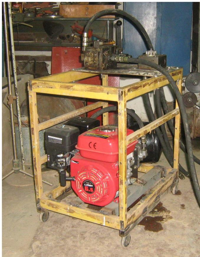
*Рисунок 5 - Общий вид насосной станции МПУ-16*
