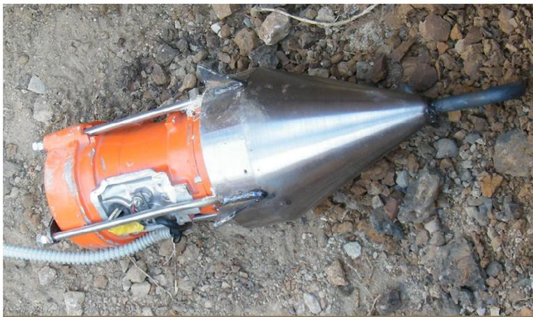
Рисунок 7- Общий вид вибрационного наконечника
