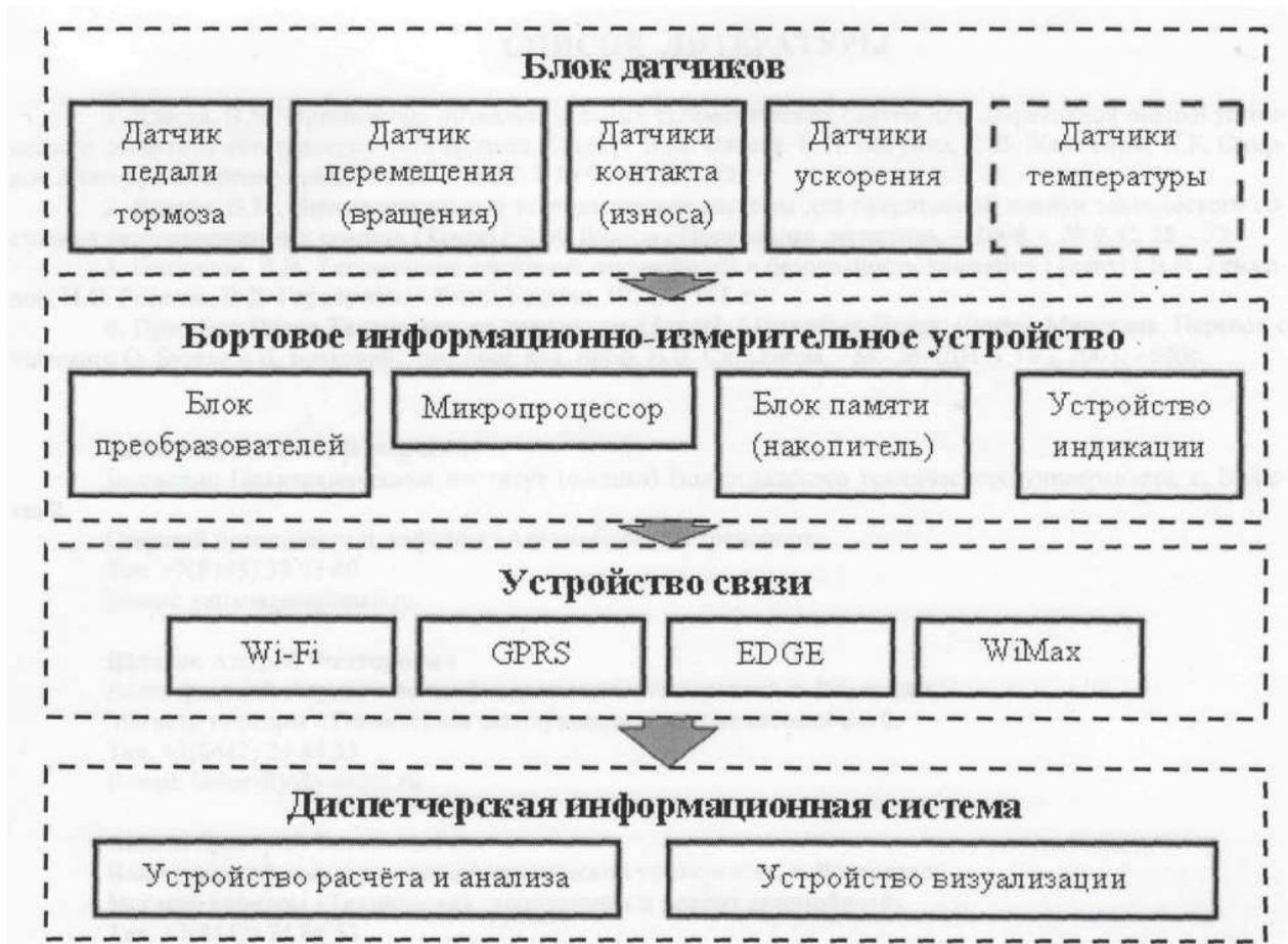
Рисунок 1 - Система оперативного контроля и мониторинга режимов работы тормозной системы автомобиля (пример при наличии антиблокировочной системы)
