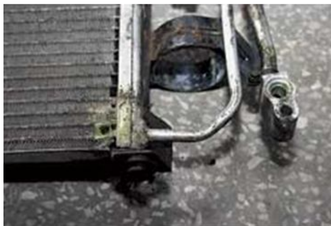
Рисунок 1 – Внешний вид коррозионных повреждений конденсатора
