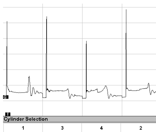
Рисунок 2 - Осциллограмма вторичного напряжения: причиной заниженного напряжения пробоя является плохая герметичность камеры сгорания
