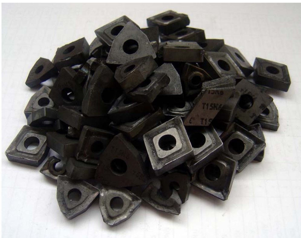
Рисунок 2 – Отходы спеченного твердого сплава марки Т15К6
