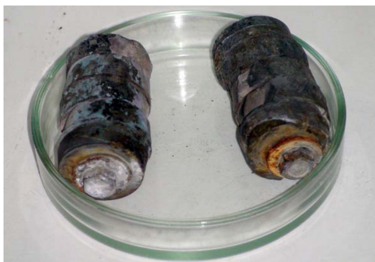
Рисунок 3 – Электроды, набранные из пластин спеченного твердого сплава марки ВК8
