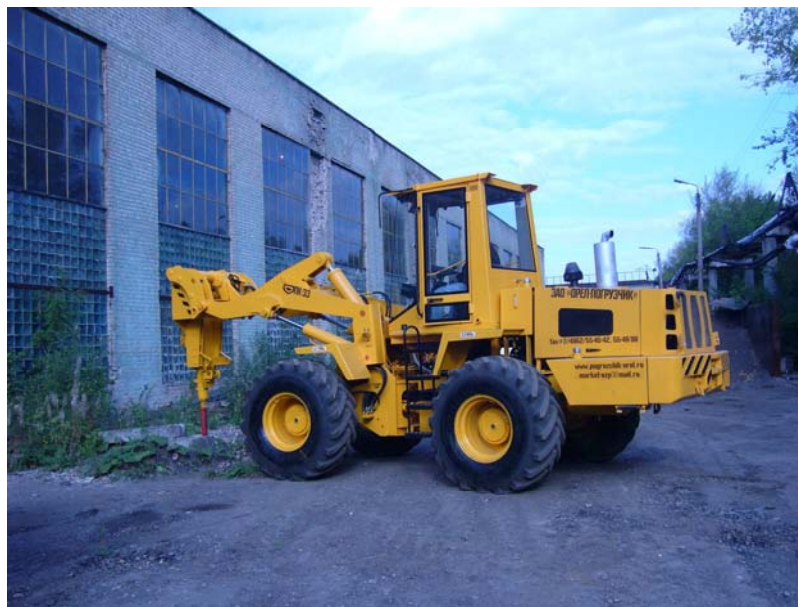
Рисунок 1- Колесный погрузчик, оснащенный гидроударником
