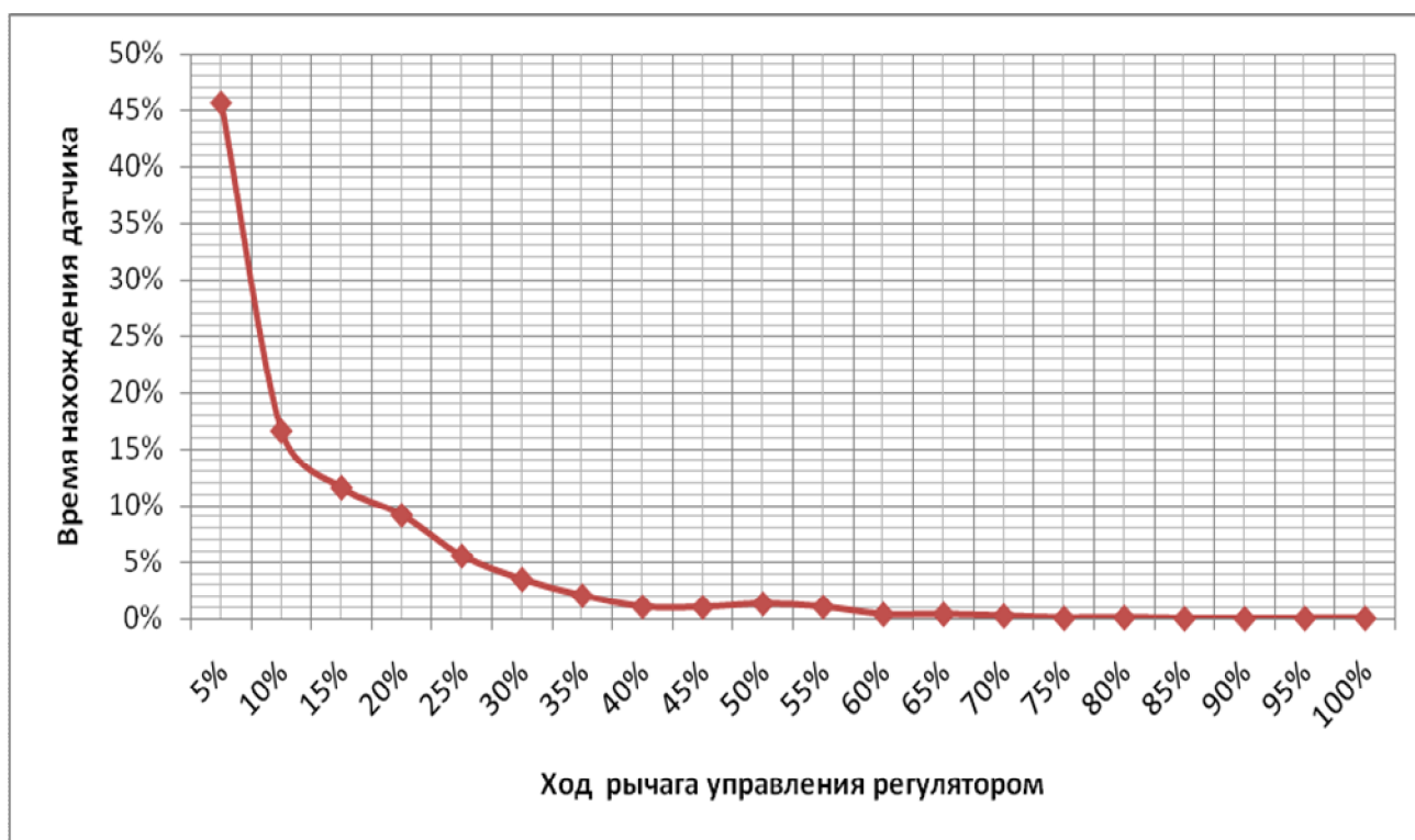
Рисунок 1 – Распределение времени по диапазонам рычага управления регулятором
