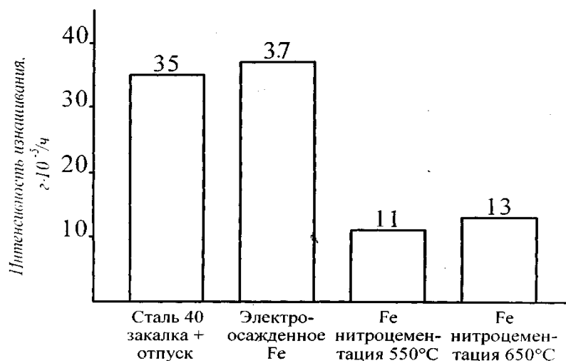
Рисунок 2 - Интенсивность изнашивания электроосажденного железа при граничном трении
