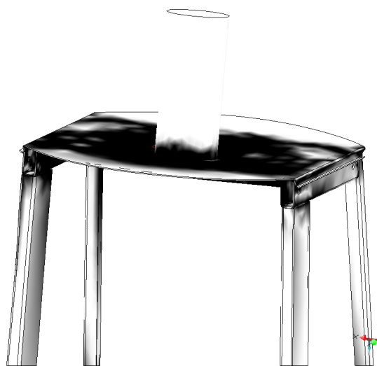
Рисунок 6 - Распределений напряжений в конструкции кабины при её взаимодействии с падающим телом
