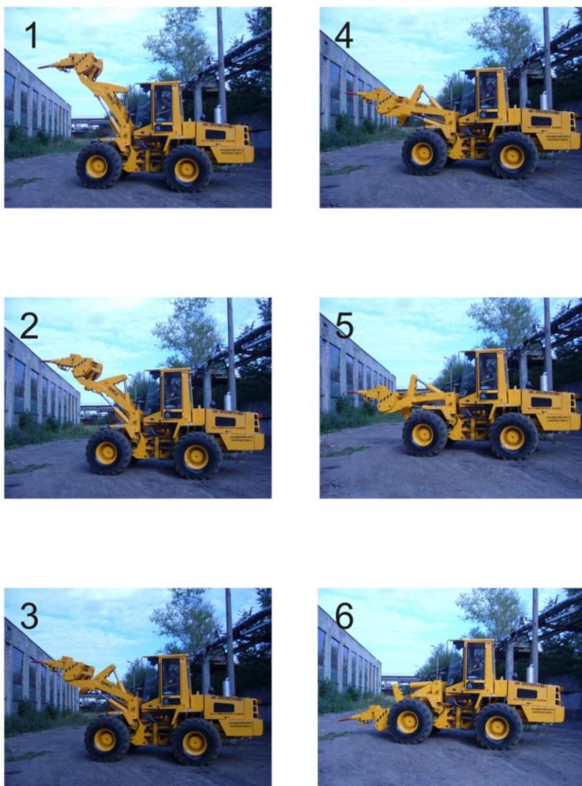
Рисунок 1 - Фиксированные положения зоны обслуживания ударно-скалывающим исполнительным органом погрузчика ПК-33 в вертикальной плоскости
