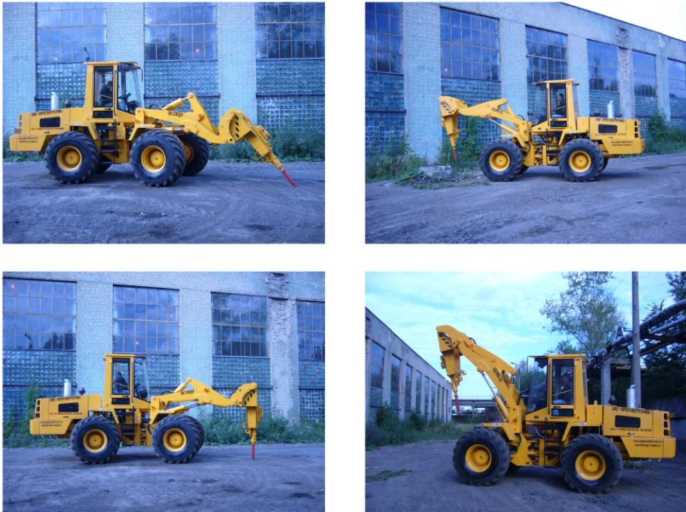
Рисунок 2 – Варианты вертикальной фиксации гидроударника
