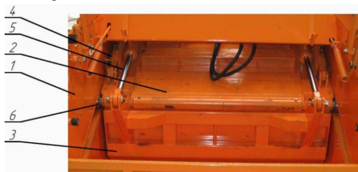
Рисунок 2 – Механизм прессования мусора в мусоровозе КО – 427: 1 – корпус контейнера; 2 – подающая плита; 3 – прессующая плита; 4 – гидроцилиндр подающей плиты; 5 – гидроцилиндр прессующей плиты; 6 – подшипник
