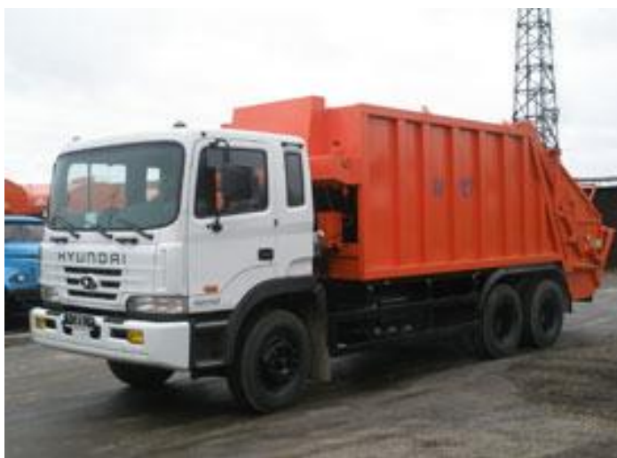
Рисунок 1 – Мусоровоз серии КО–427 с задней загрузкой кузова
