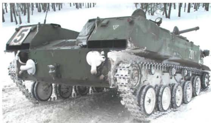
Рисунок 10 – Обледенение ГД БМД-1 при движении
