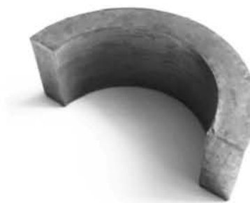
Рисунок 5 – Образец для измерения параметра микротвёрдости
