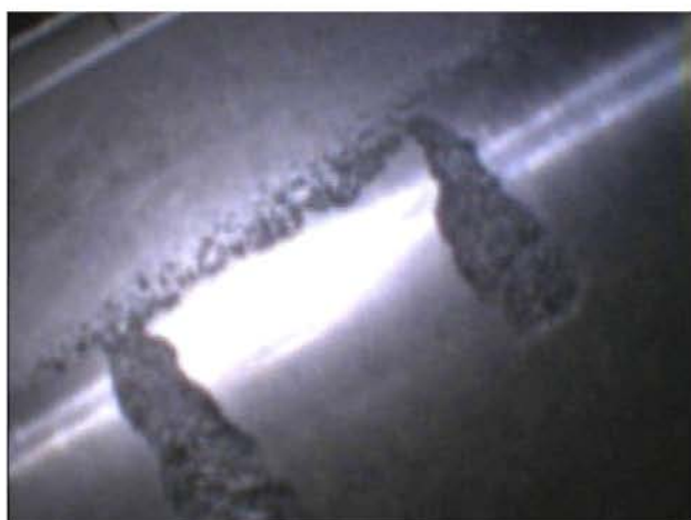
Рисунок 10 – Изображение стенки цилиндра двигателя R5, полученное с помощью технического эндоскопа
