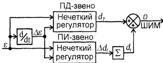
Рис. 4. Структура нечеткого ПИД-регулятора
