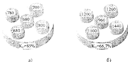
Рис. 3. Распределение напряжения пробоя покрытия по поверхности образца, сформированного на сплаве Д16Т в ГС режиме при I_S = 20 \text{ А/дм}^2 , времени оксидирования T = 2 \text{ ч} . и C_{\text{KOH}} = 1 \text{ г/л} : а) C_{\text{Na}_2\text{SiO}_3} = 5 \text{ г/л} ; б) C_{\text{Na}_2\text{SiO}_3} = 30 \text{ г/л}
