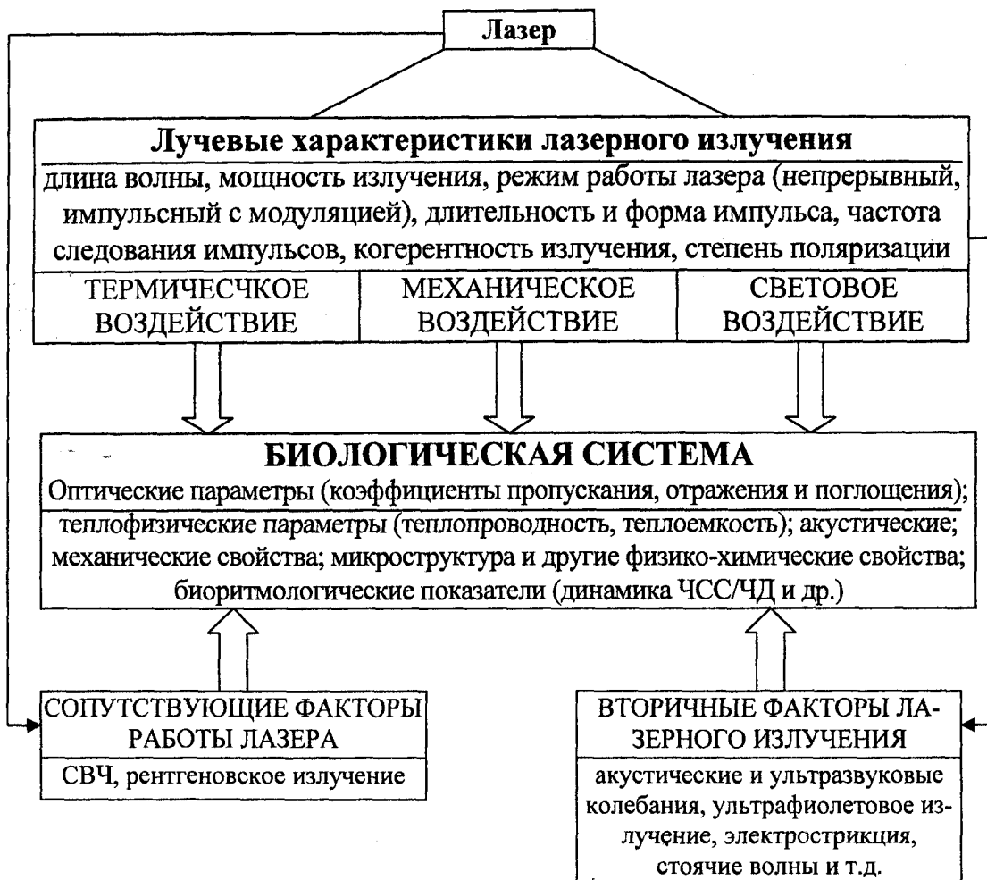
Рис. 3. – Схема взаимодействия лазерного излучения с биологической тканью
