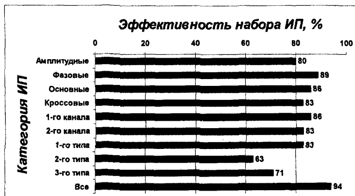
Рис. 8. – Эффективность различных категорий ИП после оптимизации (определение типа дефекта)
