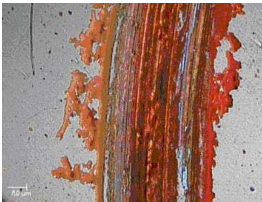
Рисунок 4 – Микрофотография дорожки износа, полученная на оптическом микроскопе AXIOVERT CA25 (Karl Zeiss, Германия), \times 100
