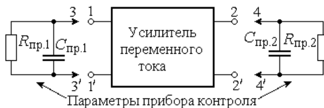
Рисунок 4 – Эквивалентные схемы цепей прибора контроля для измерения коэффициента усиления
