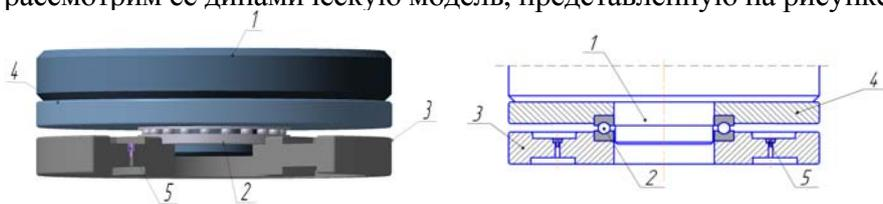
**Рисунок 1 – 3D-модель и схема упорной совмещенной опоры**
