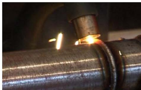
*Рисунок 4 – Наплавка в среде углекислого газа*
