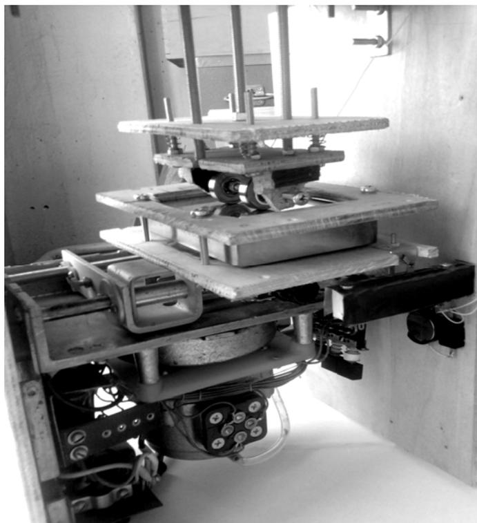
**Рисунок 3 – Установка для моделирования пары трения**
