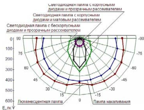
Рисунок 4 - Диаграммы направленности электромагнитного излучения ламп разных типов
