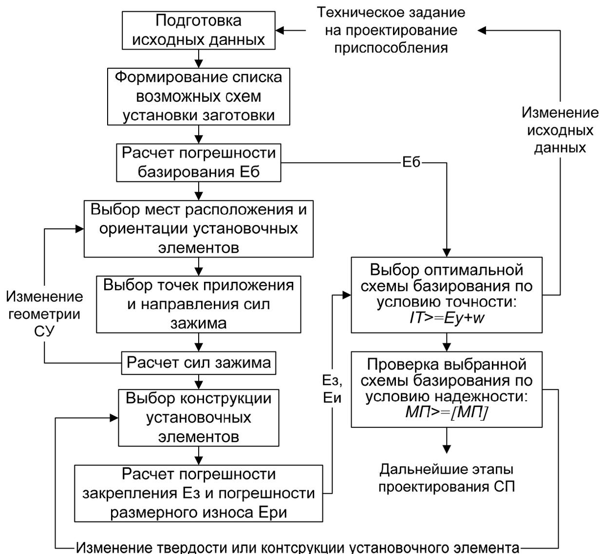
*Рисунок 1- Схема проектирования станочных приспособлений*
