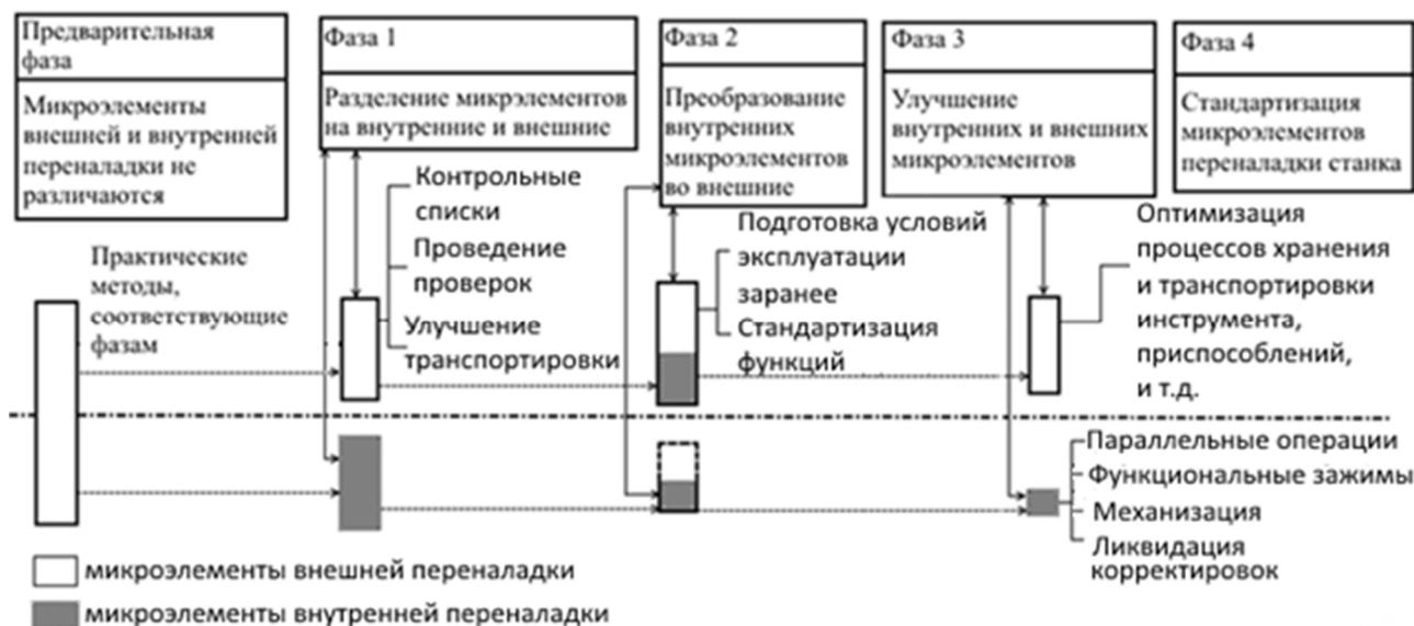
Рисунок 3 – Фазы анализа элементов и микроэлементов переналадки станка
