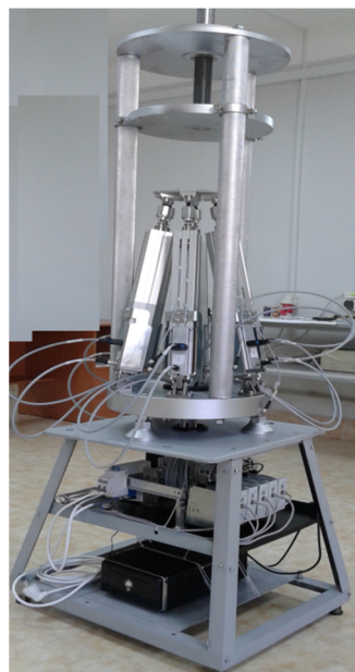
Рисунок 9 – Стенд – симулятор для испытаний имплантов позвоночника человека (Лаборатория биомеханики г. Севастополь)
