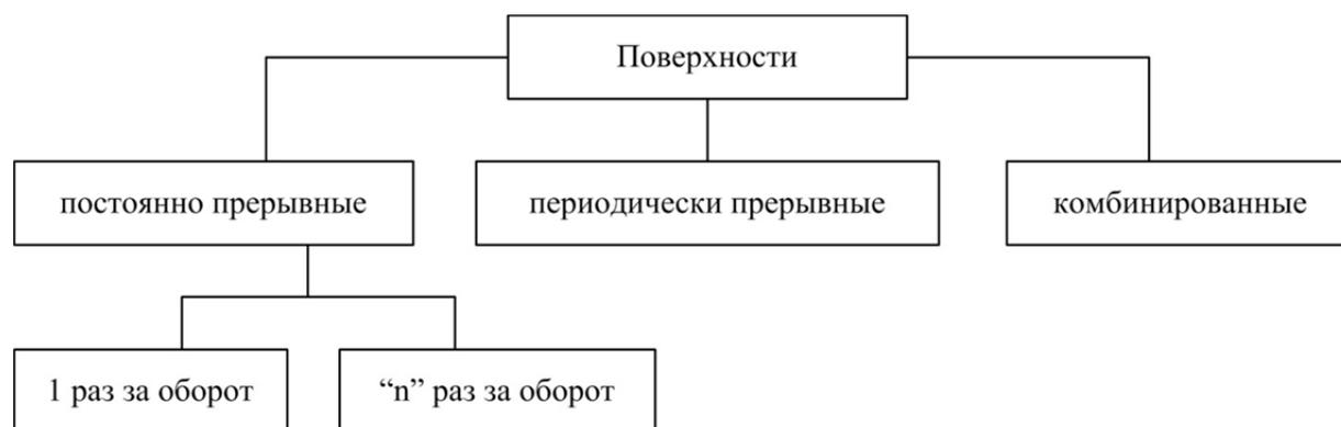
*Рисунок 6 – Классификация по условиям прерывания обрабатываемой поверхности*
