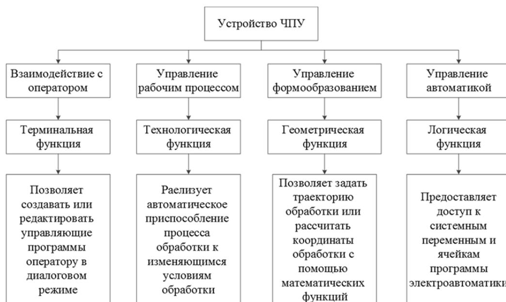
**Рисунок 1 – Возможности использования параметрического программирования при реализации основных функций системы ЧПУ**
