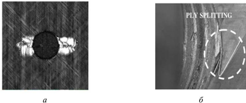
Рисунок 4 - (а) C-Scan перед началом полного разрушения; (б) увеличенный снимок при нагрузке 22.7кН (отмечен отделившийся слой). Нагрузка прикладывалась вертикально
