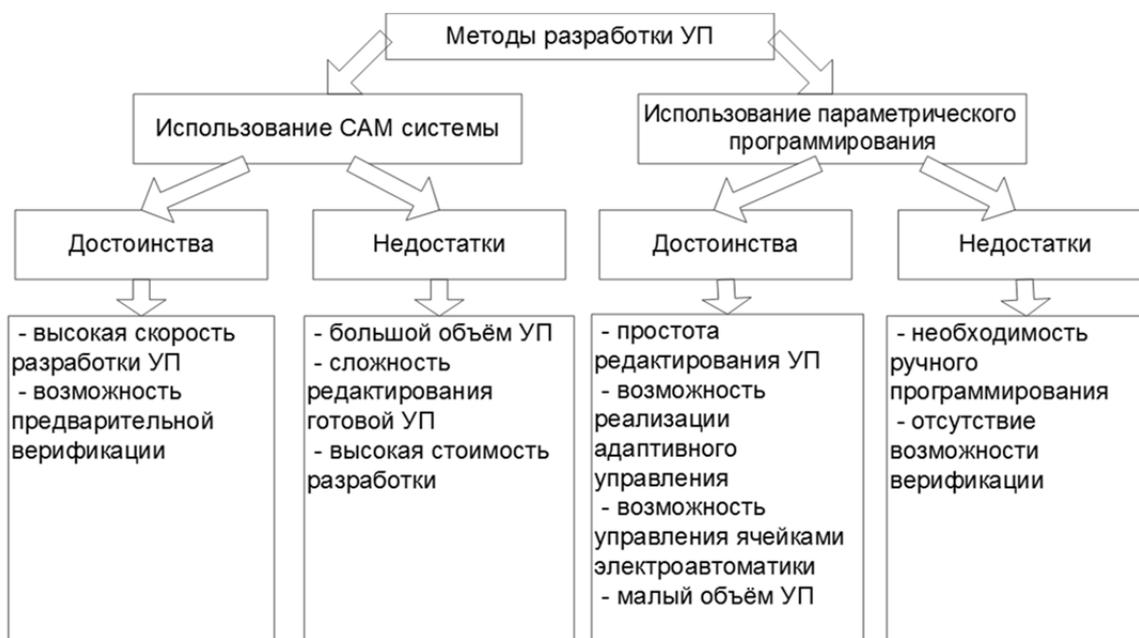
*Рисунок 4 – Сравнительный анализ метода параметрического макропрограммирования и программирования с использованием САМ-систем*
