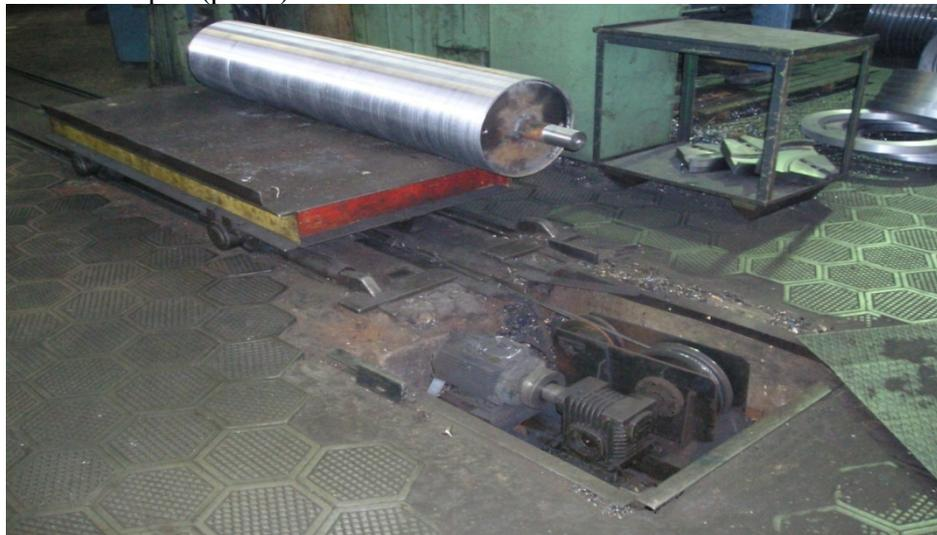
Рисунок 1 – Пускозащитная муфта в приводе тележки для транспортировки изделий
