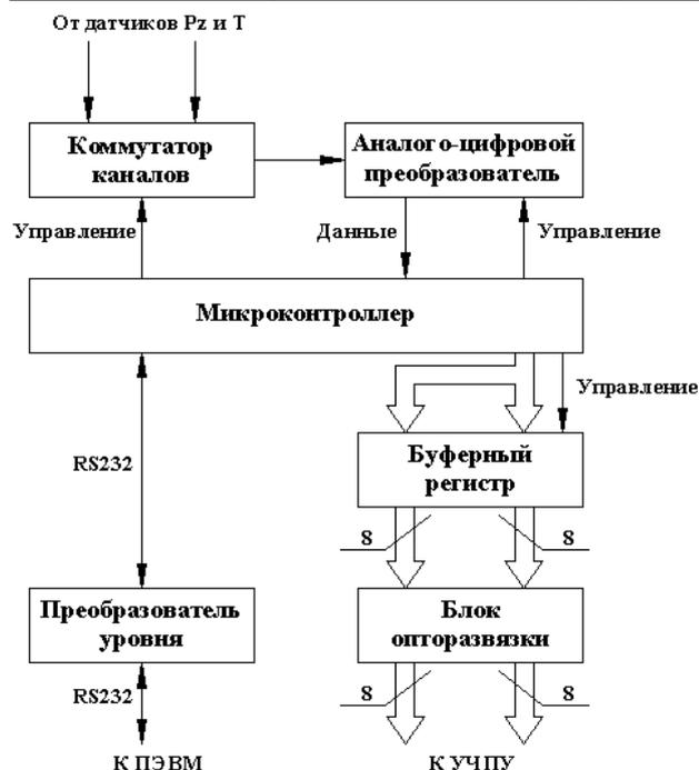
Рисунок 1 – Структурная схема модуля сопряжения
