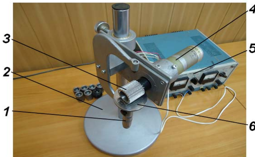
1 – микровинт; 2 – основание; 3 – рифленный валок; 4 – электродвигатель; 5 – блок питания; 6 – контактная поверхность.
