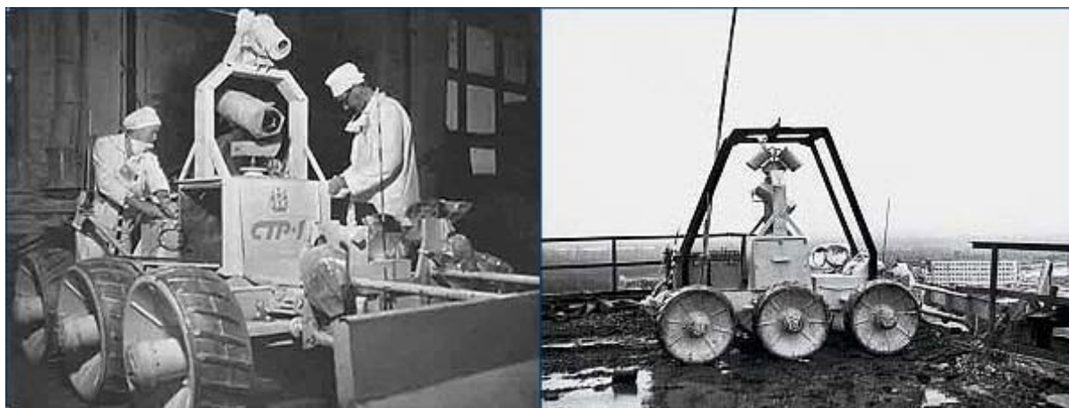
Рисунок 2 – Робот СТР-1 выполняющий работы на кровле ЧАЭС
