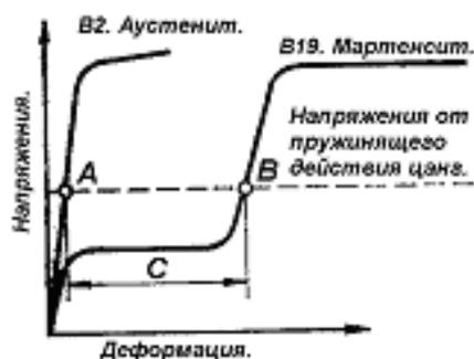
Рисунок 3 – Диаграммы силовых характеристик кольца из сплава Ti-Ni
