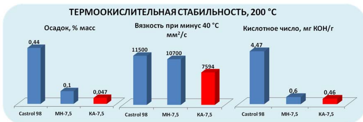
Рисунок 3 – сравнение эксплуатационных свойств масла КА-7,5 и отечественных и зарубежных аналогов
