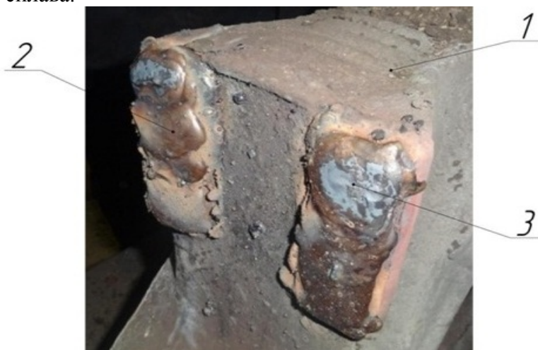
Рисунок 1 – Наплавленные прерывистые поверхности боковой рамы, подлежащие торцовому фрезерованию
