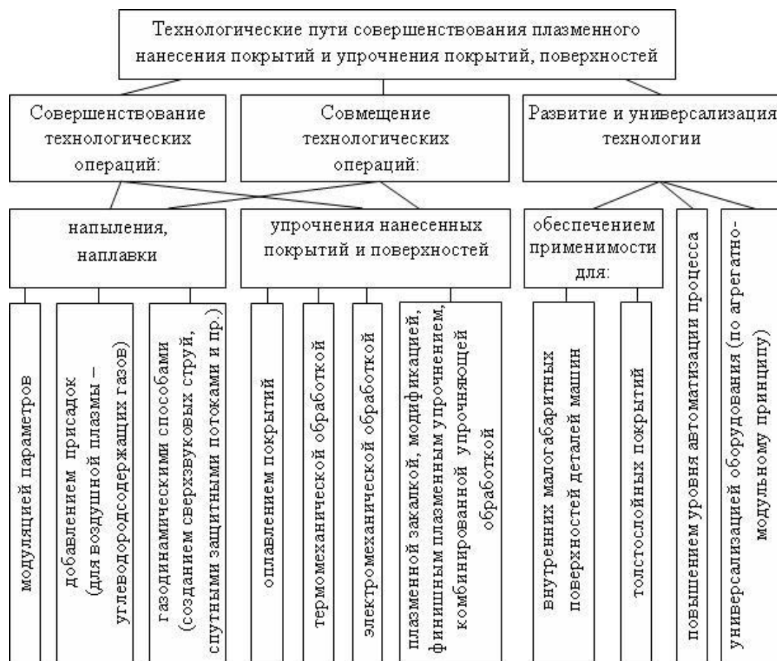
Рисунок 2 – Технологические пути совершенствования плазменного нанесения покрытий и упрочнения покрытий, поверхностей
