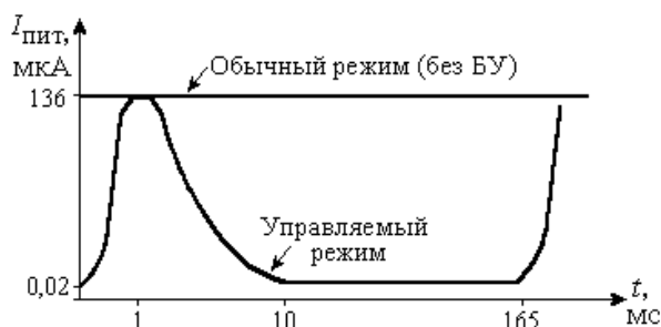
Рисунок 6 – Графики потребления тока измерительной частью влагомера в обычном и в управляемом режимах работы
