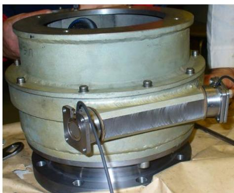
Рисунок 2 – Вид на основание корпуса редуктора привода со стороны двух датчиков силы
