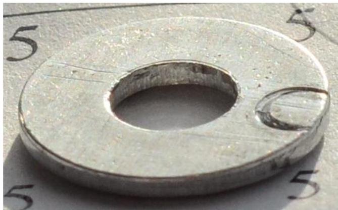
**Рисунок 6 – Шайба, полученная при первичной деформации 40%, реверсивной 40%**
