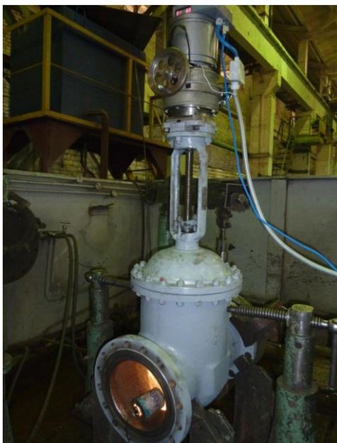
Рисунок 6 – Электропривод 7МРЭП в комплекте с задвижкой
