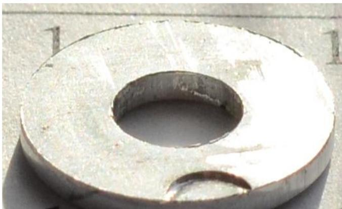
**Рисунок 5 – Шайба, полученная при первичной деформации 10%, реверсивной 40%**
