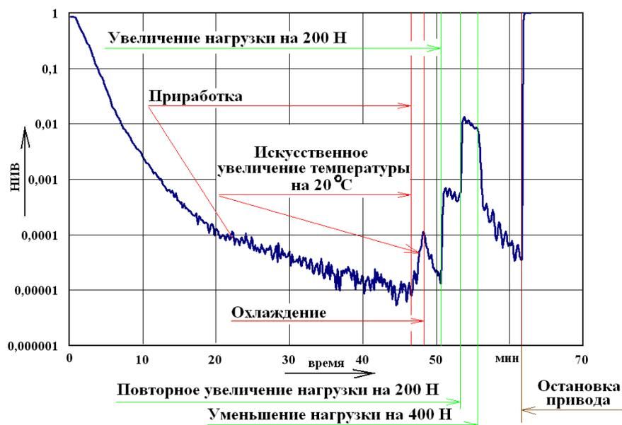
*Рисунок 2 – Изменение параметра НИВ при возникновении неустойчивости фрикционного контакта*
