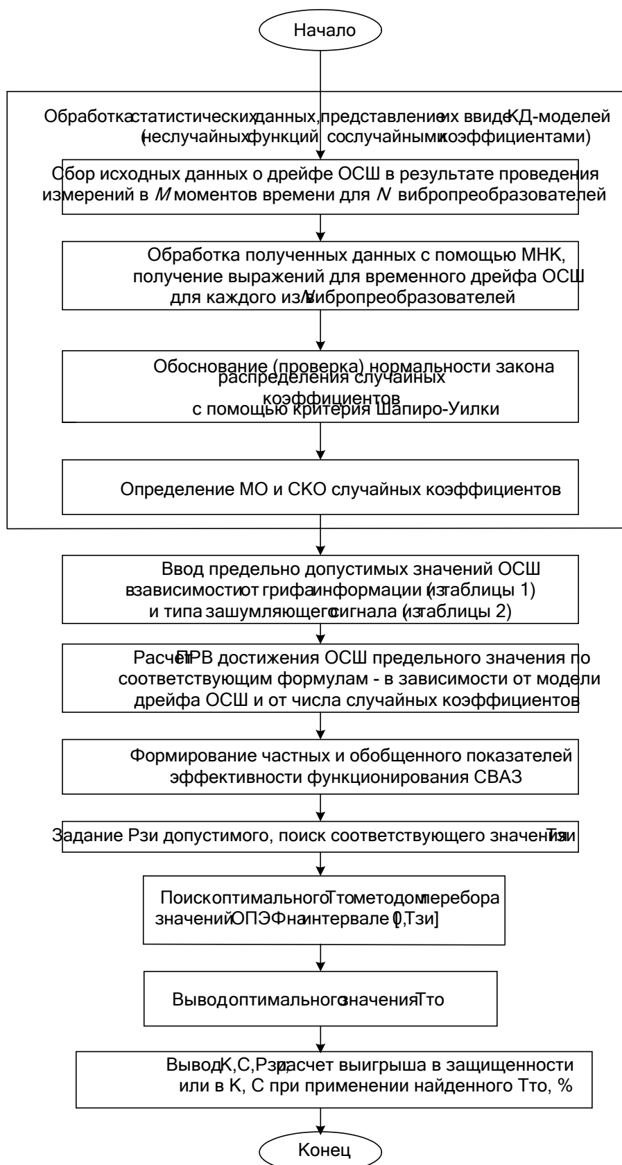
Рисунок 1 – Алгоритм определения оптимального периода ТО СВАЗ
