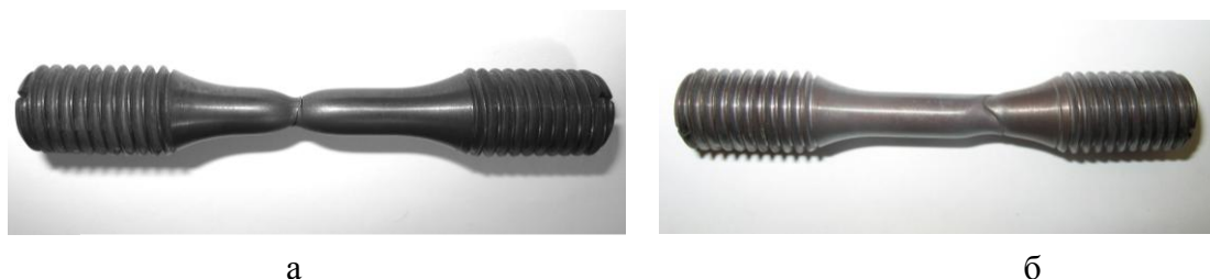
Фотография 5 – Образование шейки в образцах при разрушении а – образец № 6; б – образец № 12
