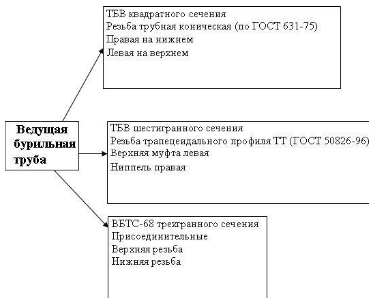
Рисунок 1 – Классификация резьб на ведущих бурильных трубах
