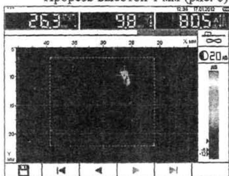
Рисунок 6 – Изображение прорези высотой 1 мм
