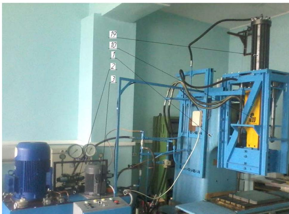
*Рисунок 1 – Установка для упрочнения волной деформации*
