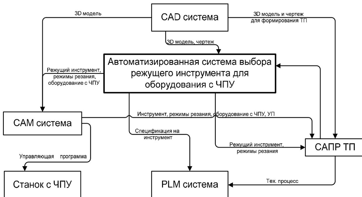
Рисунок 1 - Место программного комплекса по выбору режущего инструмента в интегрированной САПР предприятия
