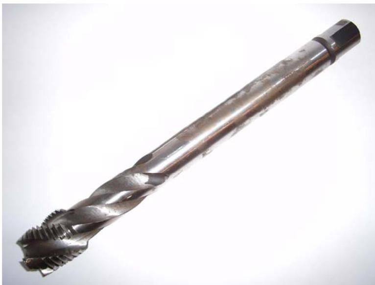
*Рисунок 2 - Специальный одинарный метчик с винтовыми стружечными канавками*
