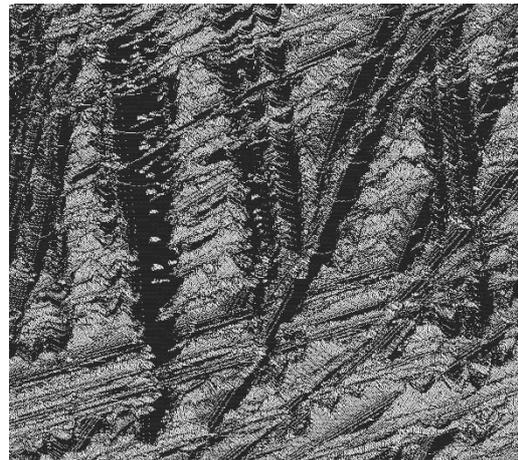
Рисунок 2 – Топография обработанной поверхности предлагаемым способом (увеличено в 5000 раз)
