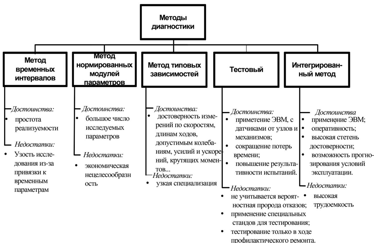
Рисунок 1 - Методы диагностирования станков и станочных комплексов
