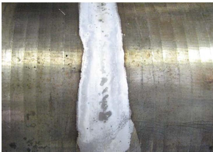
Рисунок 2 – Внешний вид поверхности подвергнутой плазменной закалке на токе обратной полярности.
