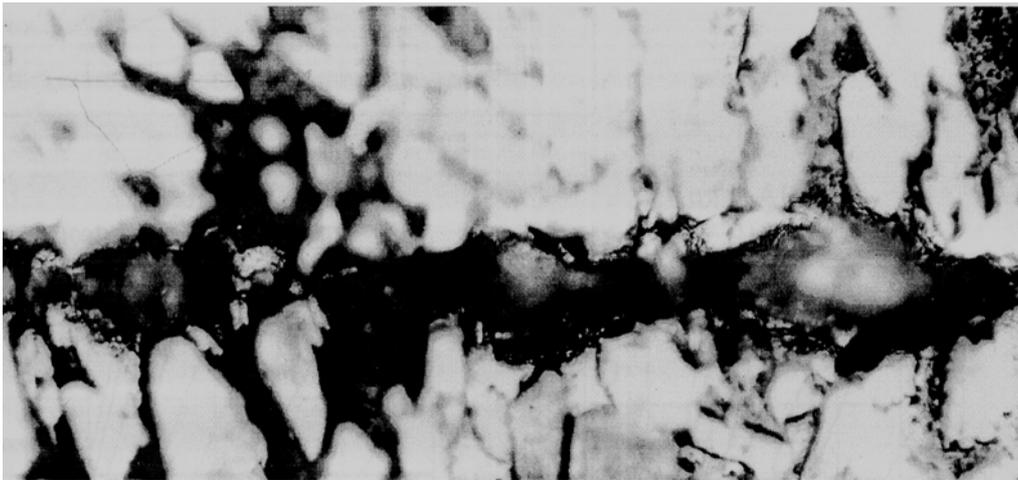
*Рисунок 1 – Профиль поперечного сечения зазора металл-металлического соединения (межконтактный зазор выделен черным цветом)*
