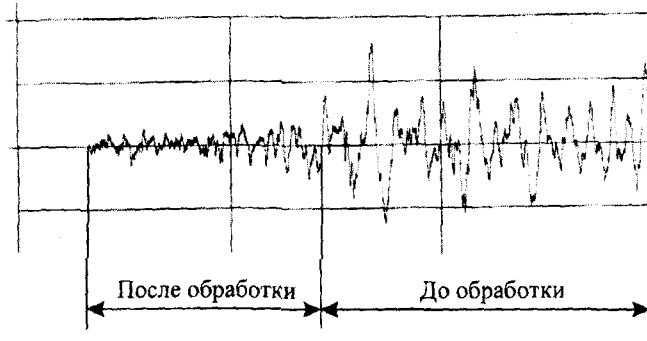
Рисунок 2 – Сравнение профиля шероховатости боковой поверхности резьбы до и после ОУО ППД
