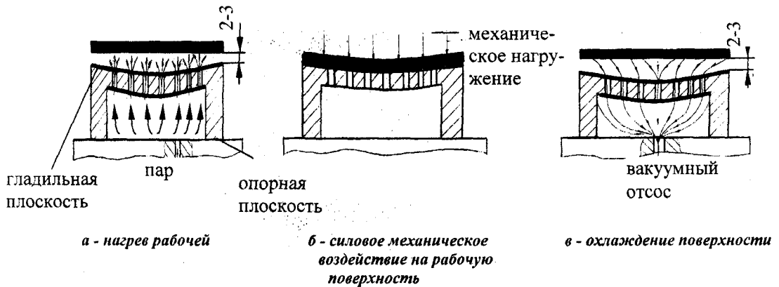
Рисунок 1 - Основные приемы одного цикла тепломеханического выпрямления рабочей поверхности
