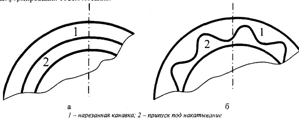
Рисунок 2 - Схемы деформирования при комбинированной режуще-деформирующей обработке резьб в радиальном сечении заготовки
