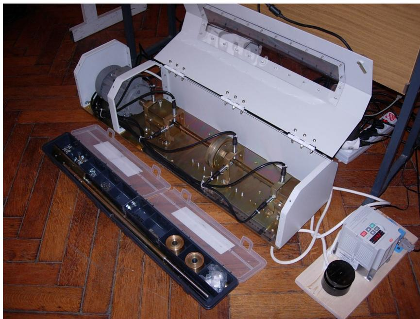
*Рисунок 3 – Лабораторная установка по исследованию роторно-опорных узлов*
