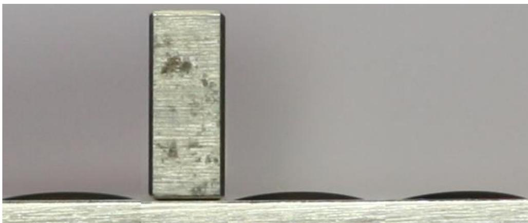
*Рисунок 1 – Пример изображения пластины с тремя каплями исследуемого смазочного материала и концевой мерой длины заданного размера*
