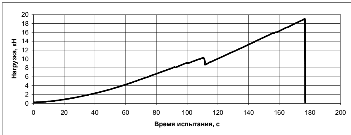
Рисунок 7 – Диаграмма зависимости действующей нагрузки от времени при проведение испытаний износостойкого симинала образец №3
