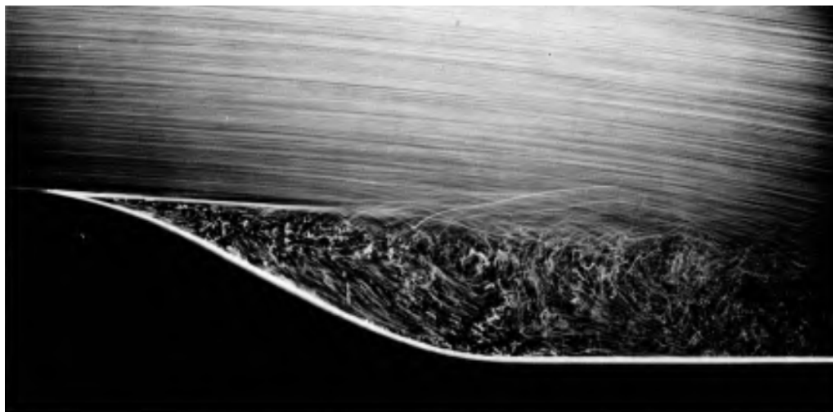
Рисунок 4 – Срыв ламинарного потока на выступе плавного профиля
