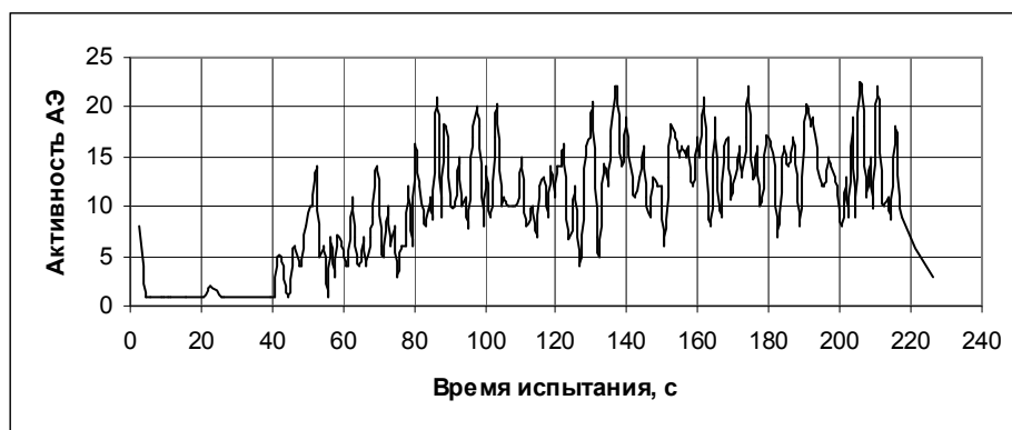
Рисунок 5 – Диаграмма акустической эмиссии во время испытания износостойкого симинала образец №2
