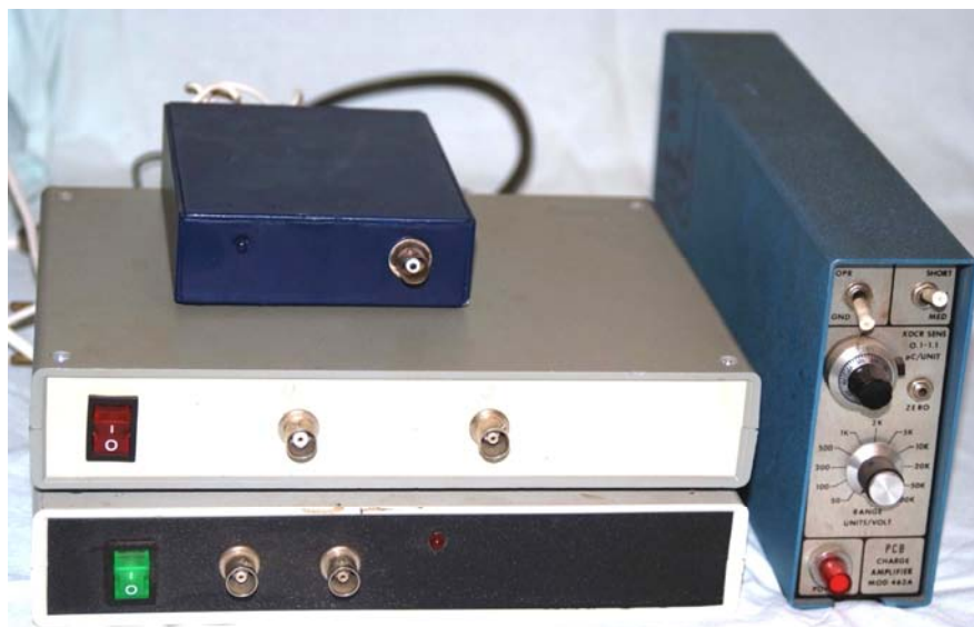
Рисунок 8 – Внешний вид модулей для измерения электрических и вибрационных параметров
