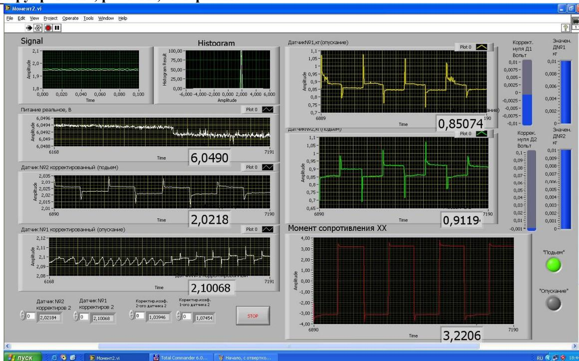
**Рисунок 7 – Лицевая панель прибора по определению момента холостого хода механизма**
