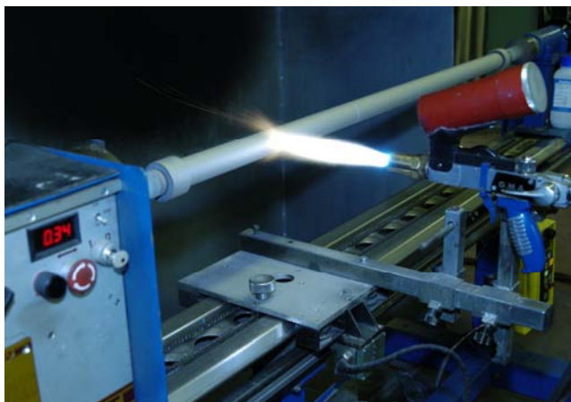
Рисунок 6 – Газопламенное напыление с оплавлением
