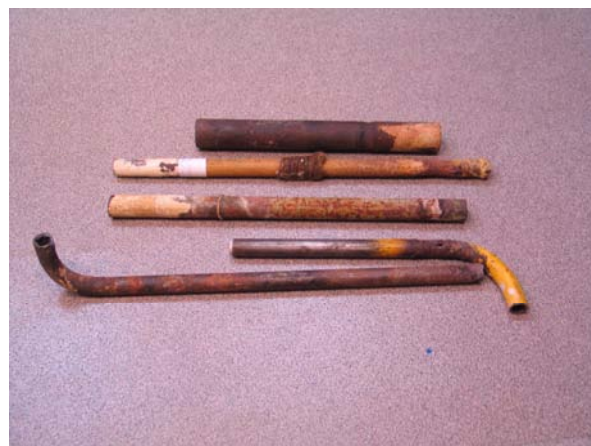
Рисунок 3 – Типовые образцы труб межэтажных перекрытий, бывшие в эксплуатации более 30 лет
