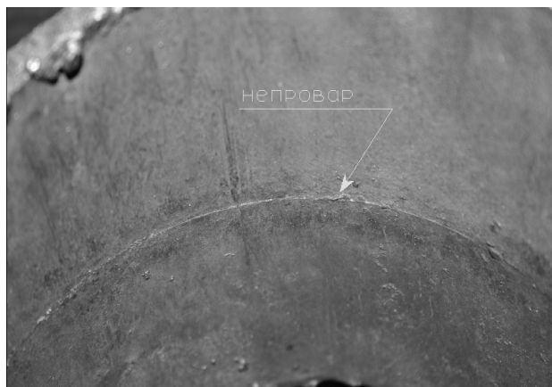
Рисунок 2 – Непровар корня шва
