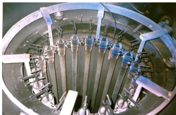
Рисунок 3 – Азотирование цилиндров штанговых насосов
