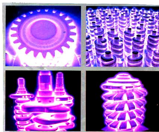
Рисунок 5 – Азотирование деталей общего машиностроения
