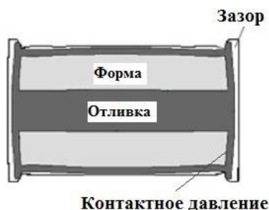
Рисунок 1 – Газо-воздушный зазор и контактное давление как результат усадки расплава и торможения ее элементами формы (на примере усадочной решетки)
