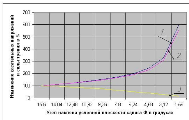
Рисунок 2 – Зависимость изменения касательных напряжений и силы трения, действующих на передней поверхности твёрдосплавного инструмента 1 – касательные напряжения, действующие на участке пластического контакта стружки с передней поверхностью; 2 – касательные напряжения, действующие на всём участке контакта стружки с передней поверхностью; 3 – кривая изменения силы нормальной реакции на переднюю поверхность
