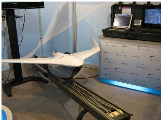
Рисунок 5 – БПЛА серии «Инспектор» на пусковой установке
