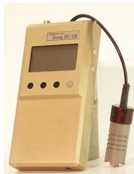
Рисунок 7- Внешний вид структуроскопа «ЗОНД ВС-04»
