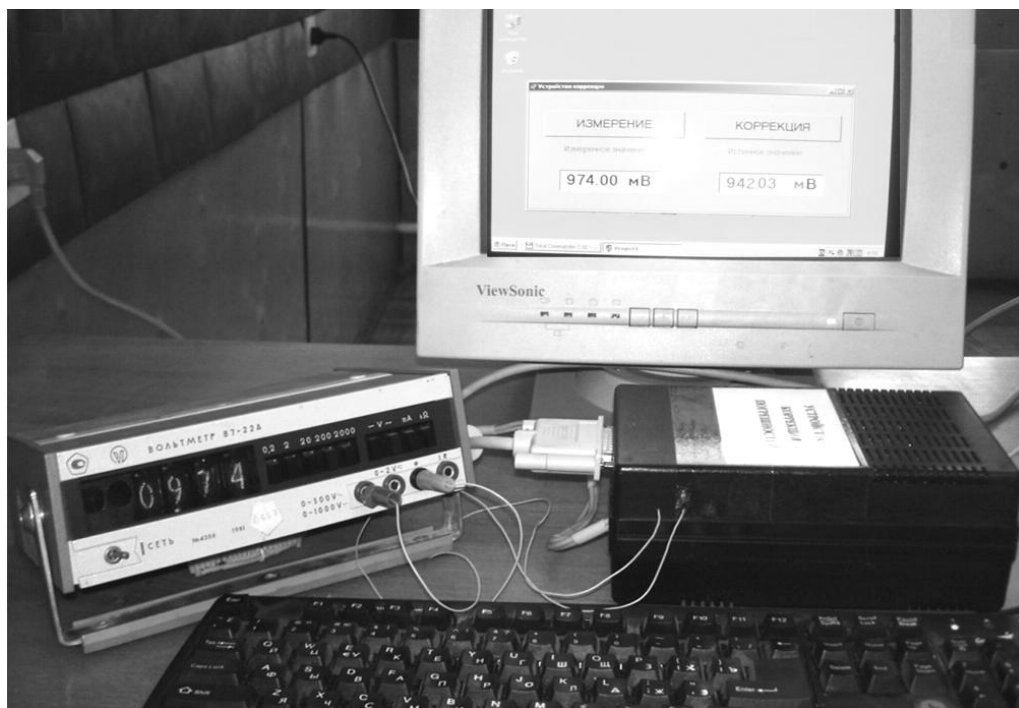
Рисунок 3 – Разработанный измерительно-вычислительный комплекс в режиме автоматической коррекции результатов измерений
