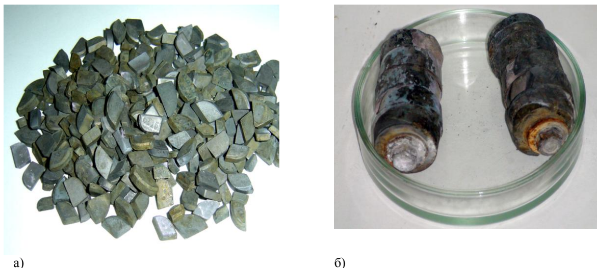
Рисунок 2 – Твердый сплав, используемый при ЭЭД а) гранулы; б) электроды
