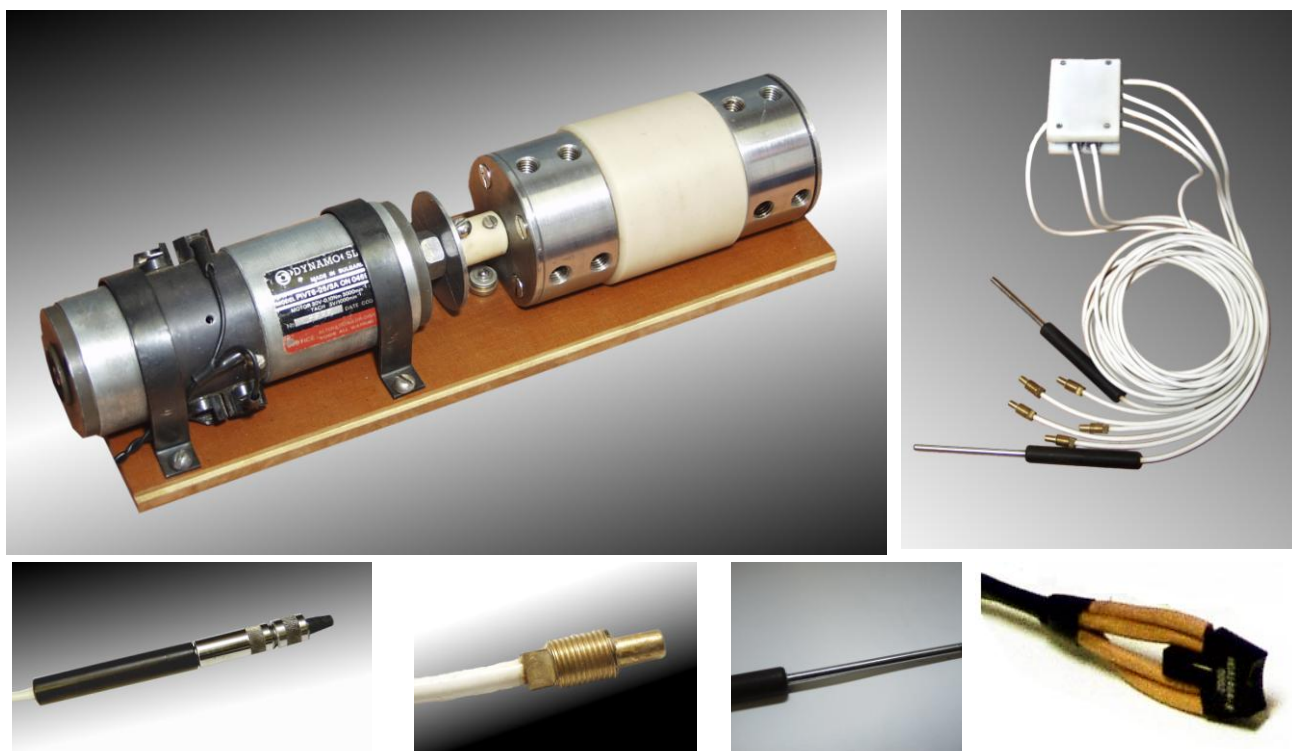
Рисунок 1 – Внешний вид лабораторной установки, коммутатора, токосъёмного устройства, датчиков температуры и положения
