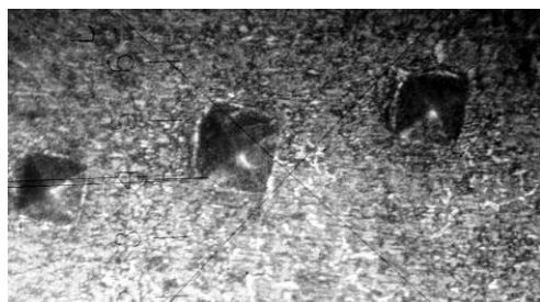
Рисунок 4 – Отпечатки алмазного индентора прибора ПМТ – 3
