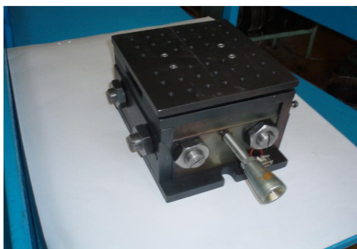
Рисунок 4 – Общий вид динамометрического устройства
