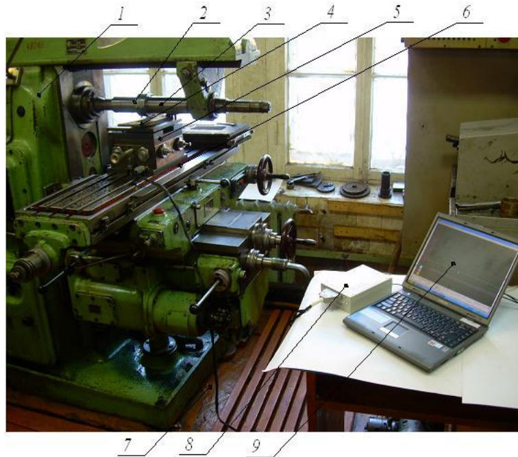
Рисунок 2 – Общий вид автоматизированной системы научных исследований (АСНИ): 1 – горизонтально фрезерный станок; 2 – режущий инструмент; 3 – оправка; 4 – образец; 5 – Блок преобразователей (динамометрическое устройство-динамометр); 6 – рабочий стол; 7 – соединительные провода; 8 – усилитель LTR 212 с АЦП; 9 – персональный компьютер
