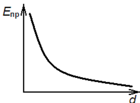
Рисунок 2 – График зависимости пробивной напряжённости воздуха от расстояния между поверхностями контактов
