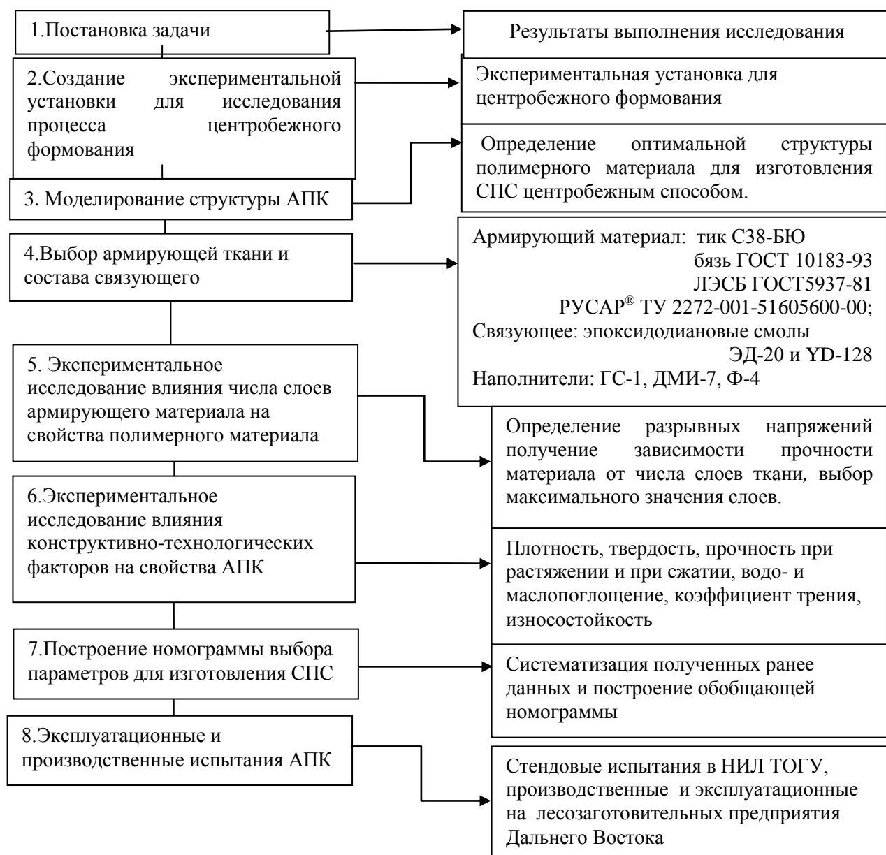
Рисунок 1 – Методика экспериментально-расчетного исследования АПК, изготавливаемых методом центробежного формования
