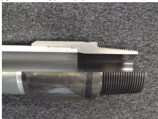
Рисунок 1 – Фрагмент легкосплавной бурильной трубы повышенной надежности
