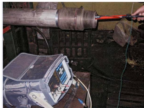
Рисунок 5 – Опробование прибора НК в условиях завода в г. Химки с использованием дефектоскопа УДС2-52 «ЗОНД-2»
