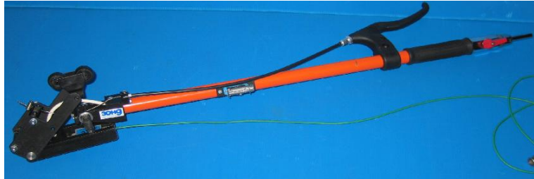
Рисунок 3 – Макет сканера УКР-1 для контроля трубной резьбы изнутри
