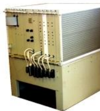
Рисунок 8 – Микропроцессорный контроллер системы управления
