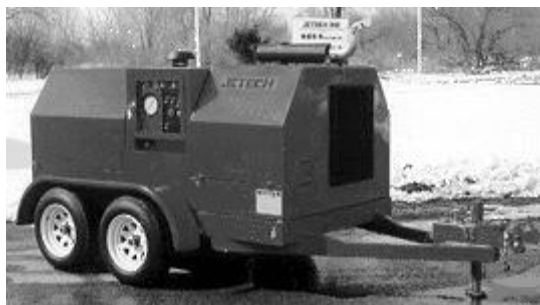
Рисунок 3 – Мобильная установка для реализации гидроструйной резки фирмы Jetech
