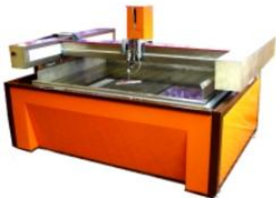
Рисунок 7 – Стол технологический с водосборником и устройством позиционирования
