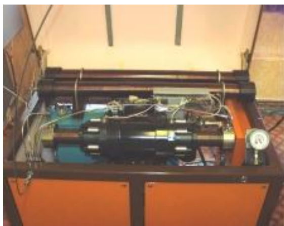
Рисунок 5 – Станция высокого давления
