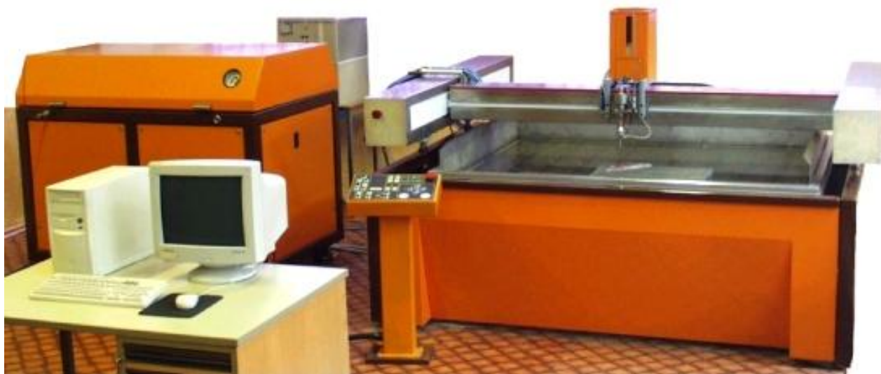
Рисунок 4 – Гидроабразивный комплекс для раскроя листовых материалов фирмы "Родень"
