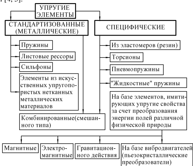
Рисунок 1 – Классификационная схема типов упругих элементов
