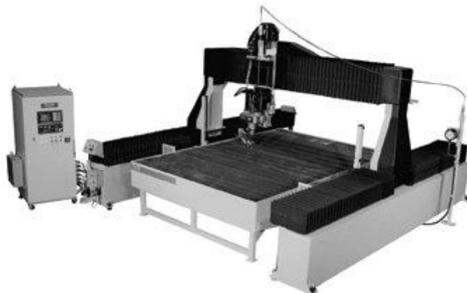
Рисунок 2 – Координатный стол AF-6080 фирмы FLOW Inc
