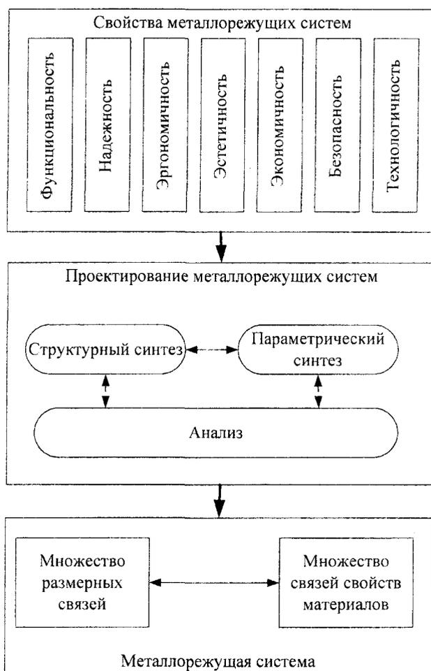
Рисунок 1 - Процесс проектирования металлорежущих систем
