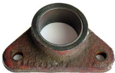
Рисунок 1 – Опора граблин жатки для уборки трав кормоуборочных комбайнов КСК-100 и КПКУ-75, восстановленная с использованием разработанной технологии
