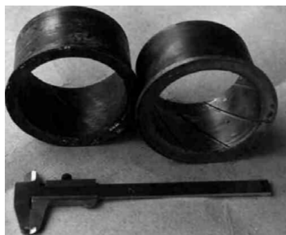
Рисунок 1 – Подшипники скольжения башмака балансирующего устройства автомобиля КамАЗ
