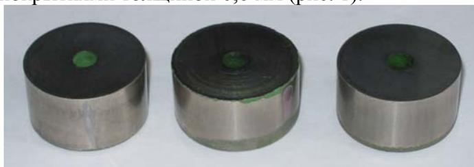
Рисунок 1 – Общий вид образцов для исследования покрытий.
