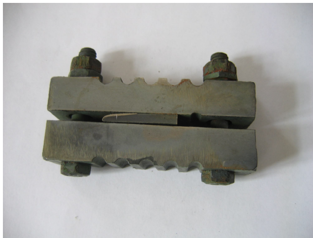
Рисунок 1 – Общий вид шлифа
