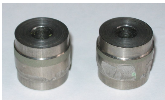
Рисунок 9 – Внешний вид образцов продавленных сквозь матрицу после испытания на сдвиг.
